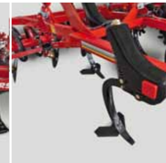
Стойки TerraGrip с лапами MulchMix
