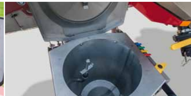
Станция для заправки пестицидов с воронкой из нержавеющей стали
