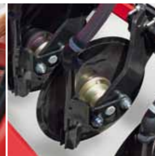
Сошник для внесения удобрений (PPF) представляет собой двойной диск не требующий обслуживания
