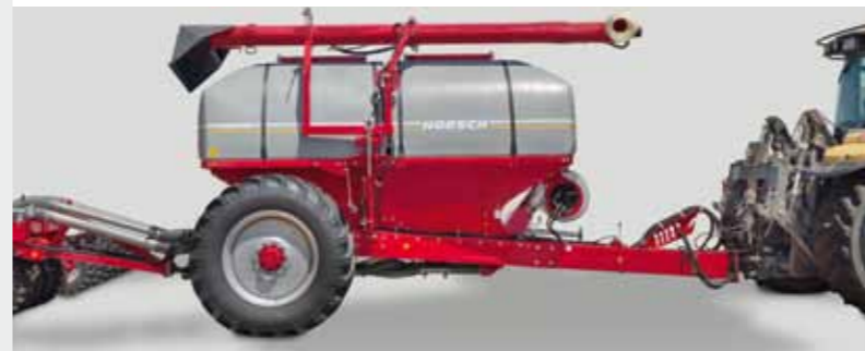
Прицепной бункер HORSCH объемом 12.000 л для семян и удобрений (50:50)
