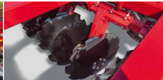
Диски большого диаметра (62 см) позволяют увеличить глубину обработки
