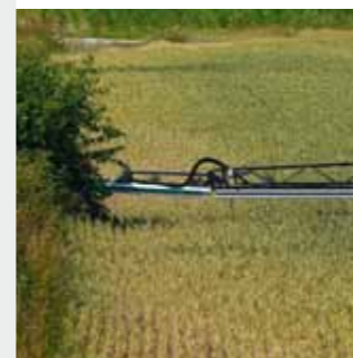
Больше безопасности Три степени защиты от наезда на препятствия непреодолимой силы на каждом крыле
