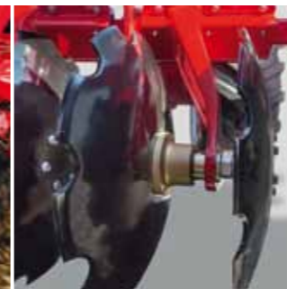
Монтаж двух дисков на одной стойке увеличивает свободное пространство в рабочей зоне машины
