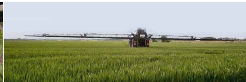
Благодаря системе BoomControl Pro 36 м штанга всегда находится на минимальном расстоянии от растений даже на полях со сложным рельефом
