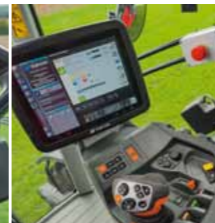
Интуитивный концепт управления машиной через сенсорную панель и джойстик
