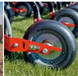
Прикатывающий ролик является опорным для сошника и регулирует глубину заделки семян
