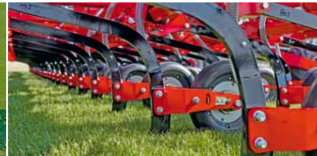
Долотообразные сошники NT освобождают посевное ложе от растительных остатков и укладывают семена во влажную почву
