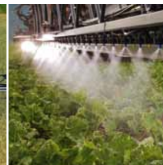
Различные типы форсунок, их комбинаций и расстановки позволяют применять интеллигентные и индивидуальные схемы опрыскивания
