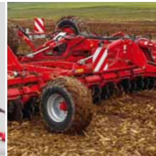
Глубина обработки регулируется изменением положения опорных колёс
