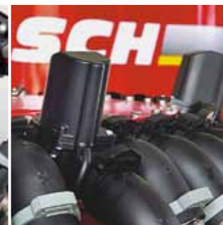
Надёжное управление включением технологической колеи с автоматической корректировкой нормы высева
