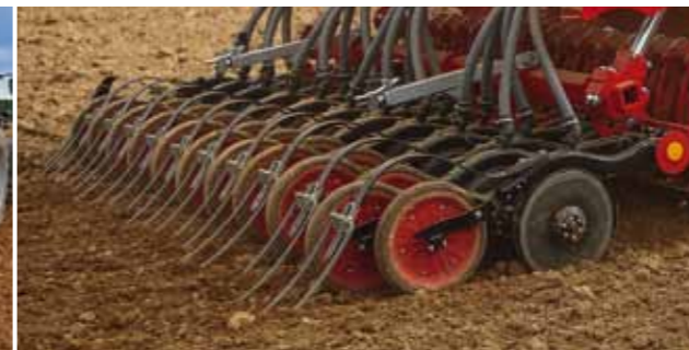
Сошники TurboDisc второго поколения обеспечивают идеальную выкладку и заделку семян. Серийно для Express TD и KR
