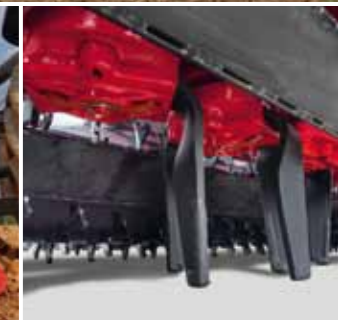
Система быстрой замены зубьев хода ротационной бороны
