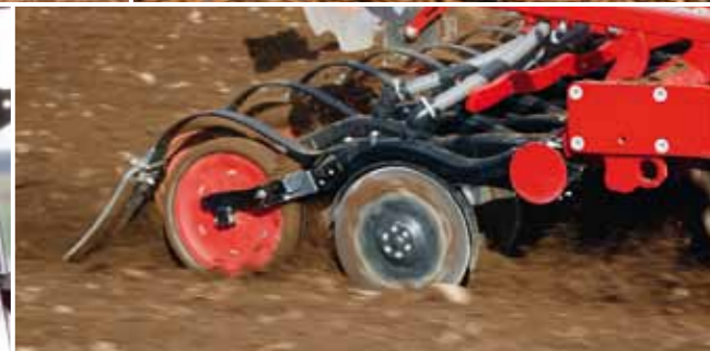
За счёт своей значительной свободы перемещения (до 15 см) сошники TurboDisc с прикапывающим колесом обеспечивают точное копирование поверхности почвы. Высокое прижимающее усилие на почву обеспечивает плавное движение сошника при высоких скоростях работы от 12 км/ч
