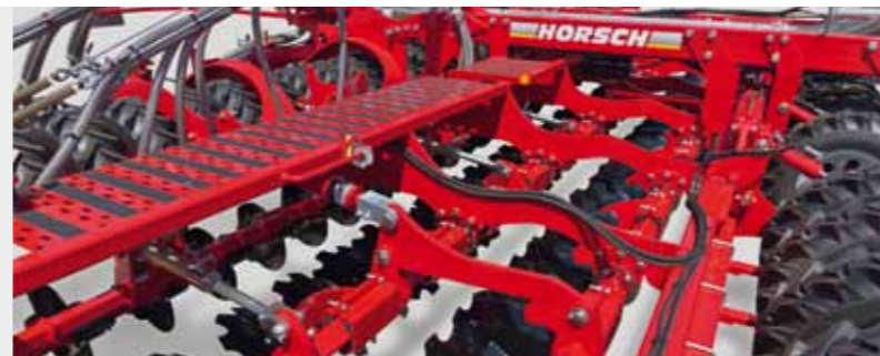
Защитные сходни над дисковой бороной для удобного доступа ко всем узлам машины
