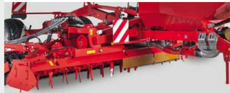
Сегменты ротационной борны подвижны и позволяют оптимально копировать почву
