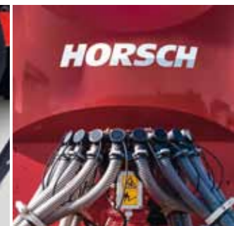
Система SeedControl не требует технологической колеи, гидр. регулировки калибровки нормы высева
