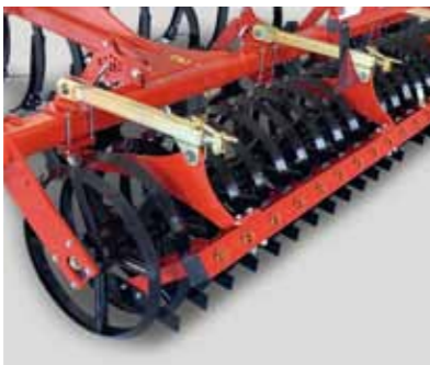
Каток RollCut с режущими элементами оставляет мелкокомковатую структуру почвы с рыхлой поверхностью.
