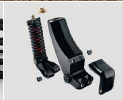
Стойка с защитой TerraGrip , высота отклонения до 30 см, усилие срабатывания до 500 кг, не требует ухода.
