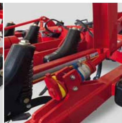
Настройка глубины хода лап при помощи алюминиевых упоров
