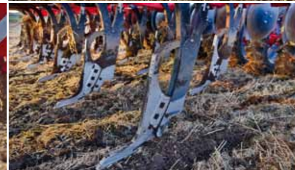
Ультра узкие наконечники Ultra LD позволяют проводить глубокую обработку почвы без образования глыбистой поверхности
