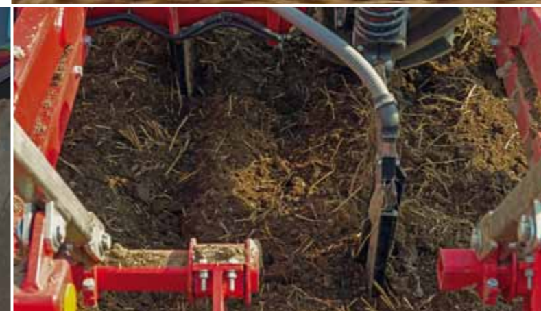
Стойки TerraGrip с разводкой пневматики для адресного внесения удобрений.
