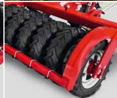
Колёсный почвоуплотнитель с самоочищающимся протектором для сплошного прикатывания.
