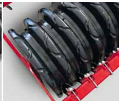
Каток FarmFlex обеспечивает оптимальное прикатывание почвы на средних и лёгких почвах и надёжен в условиях повышенной каменности.
