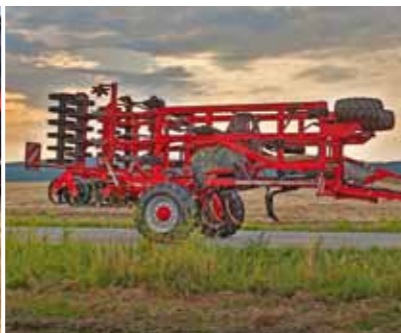
Шасси в центре конструкции для малого радиуса разворота в поле и удобства транспортировки
