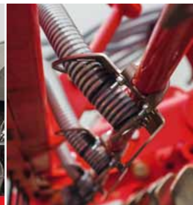
Трубчатые сошники системы MiniDrill расположены перед катком
