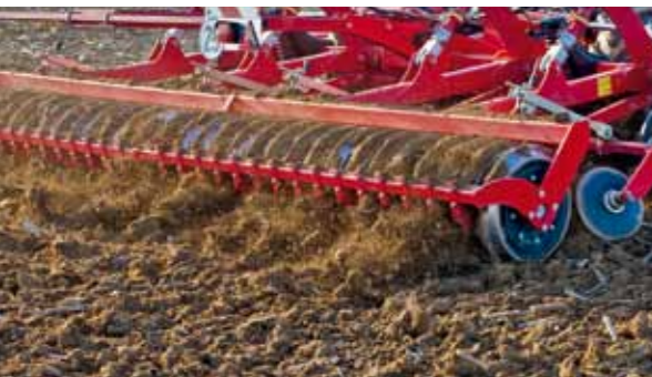
Каток SteelDisc оптимален для обратного уплотнения тяжёлых почв
