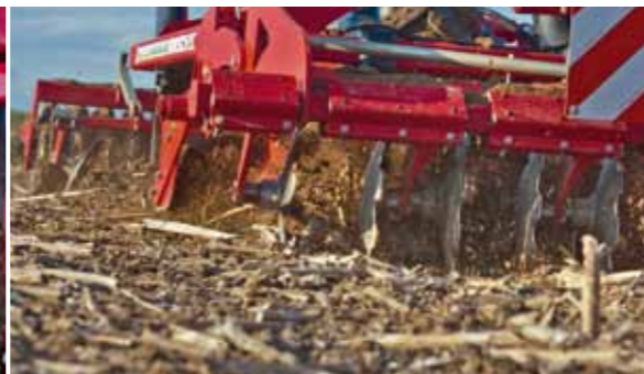
Дисковая борона DiscSystem для интенсивной заделки растительных остатков
