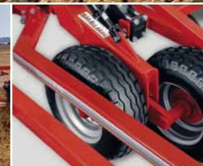
Тандемное шасси Terrano FG используется в поле как опора для точного выдерживания глубины обработки
