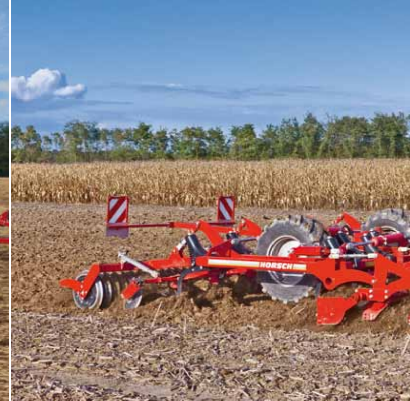
Terrano MT – комбинация лёгкой дисковой бороны и глубокорыхлителя
