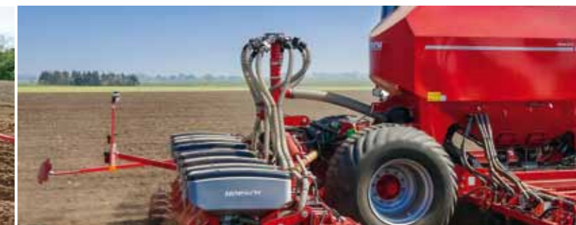
Распределитель потока семян и 3-точ. навеска (Maestro RC)
