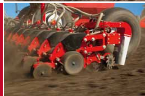
Надёжная и точная высевальная секция HORSCH – здесь в варианте Seed on Demand.
