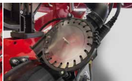
Инновационный дозирующий диск с открытыми на периферию пазами
