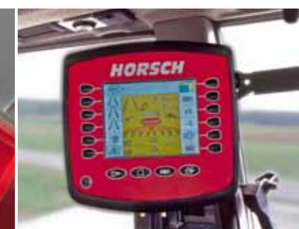
ISOBUS совместимый рабочий компьютер для управления и контроля всех функций машины
