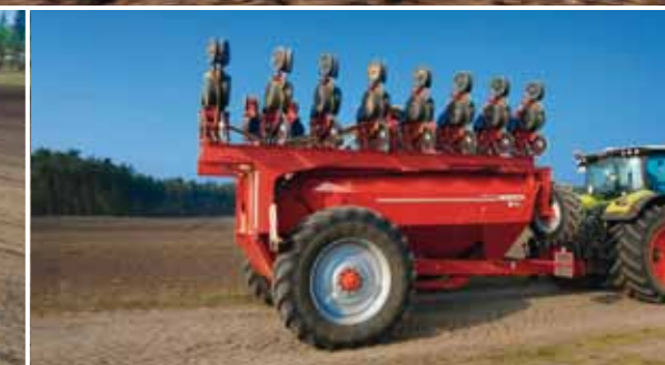
16-рядная Maestro SW при транспортировке
