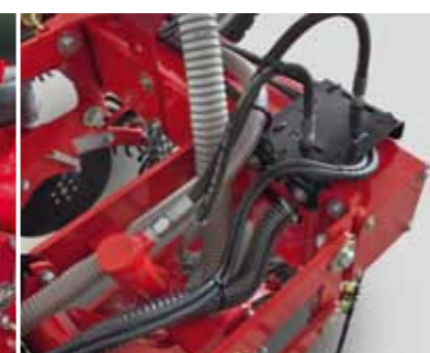
Гидравлическая регулировка давления на сошники
