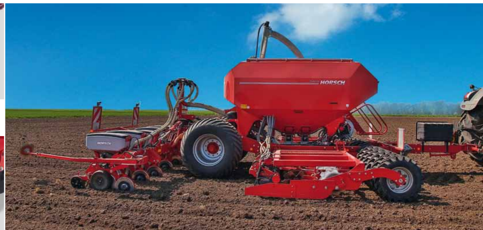
Maestro RC: Посевная секция Maestro (8 или 12 модулей) в комбинации с бункером для удобрений SW 3500 от Pronto AS. Замена секвсающей шины между Pronto и Maestro с помощью трехточечной сцепки.
