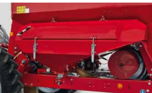
Бункер для микрогранул Maestro CC (200 л), 12/18 SW (350 л) и 16/24/36 SW (500 л) с заделкой пестицидов в борозде вместе с семенами
