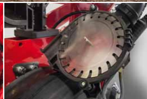
Инновационный дозирующий диск Maestro с открытыми пазами
