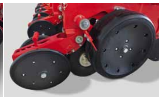
Опорный ролик со скребком, регулируемый по высоте, прикатывающий ролик и ролик-семяуспокоитель, который в условиях повышенной влажности может быть демонтирован
