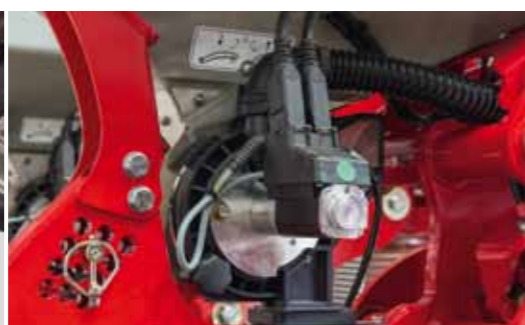
Запатентованная система дозирования – уникальна (на 09. 2011) и объединяет пневматический дозатор, электромотор и модуль управления в одном блоке
