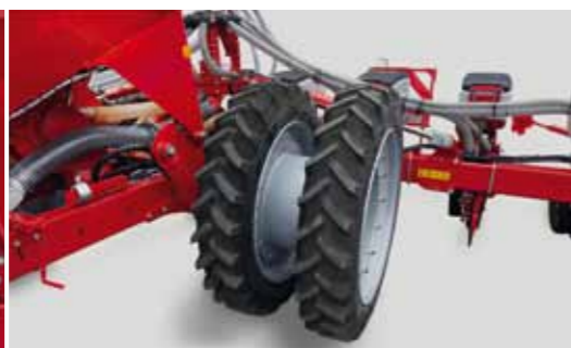
Опция: сдвоенные шины размером 230/95 R 32 для Maestro CC. Одна строчка посева располагается строго по центру между колеями спаренных колес
