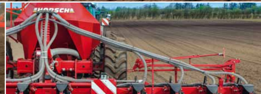
Бункер с ёмкостями для семян (2.000 л) и удобрений (7.000 л) для максимальной производительности
