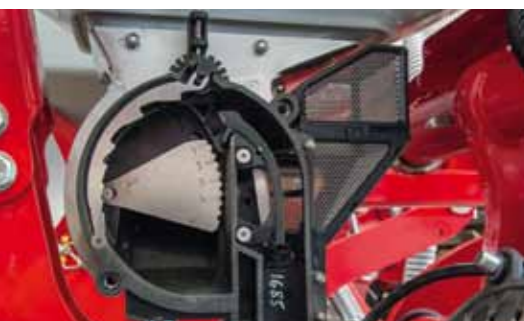
Регулируемый отсекагель направляет семя в трубку семяукладчика без возникновения центробежных сил
