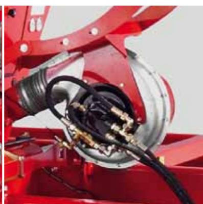
Вентилятор пневмосистемы с гидравлическим приводом
