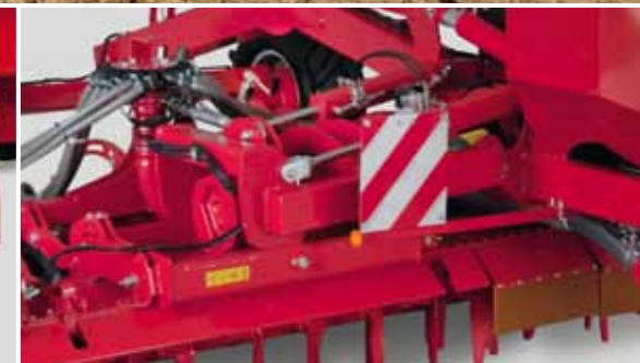
Три сегмента ротационной бороны подвижны и позволяют оптимально копировать микрорельеф поля
