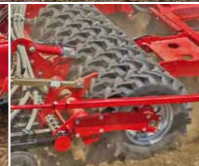
Колесный почвоуплотнитель с гибкими шипами протектора Эффективное уплотнение перед каждым из высевающих сошников
