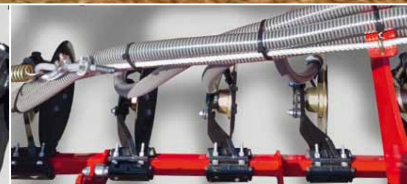
Регулируемая настройка рабочей глубины Внесение удобрений между двумя рядами посевов по центру колеса почвоуплотнителя
