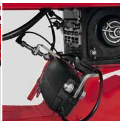
Электрическое отключение половины рабочей ширины Pronto 6 DC/AS
