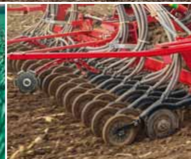
Сошник TurboDisc Посев на строго заданную глубину с высокой рабочей скоростью
