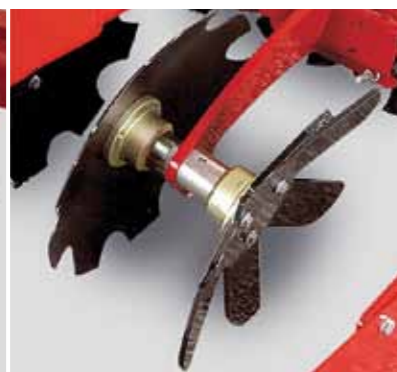
Парное расположение дисков Повышенная проходимость для более безопасной работы
