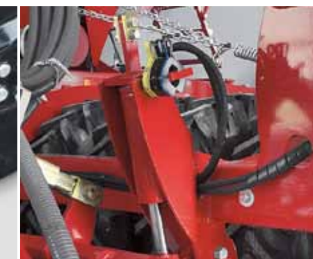
Простая настройка глубины заделки при помощи алюминиевых упоров
