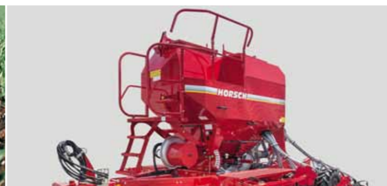
2-секционный бункер большого объёма Объём до 5.000 л, семена/удобрения (40/60 либо 50/50)
