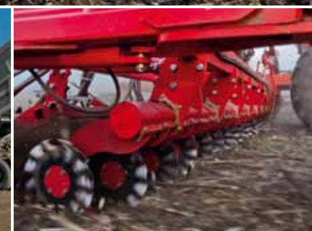
Разрезающие диски рифлёной формы эффективно обрабатывают почву и оказывают малое тяговое сопротивление
