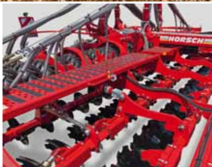
Защитные сходы над дисковой бороной для удобного доступа ко всем узлам машины
