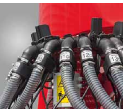
Надёжные датчики для контроля прохождения семян и удобрений
