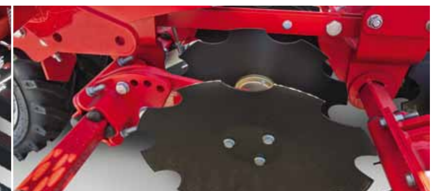
Регулировка дисковой бороны для разрыхления колеи трактора (опция)
