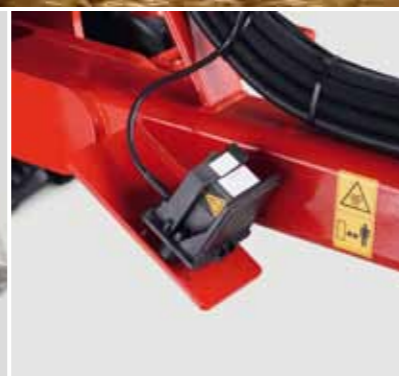
Радар (датчик скорости) Электронное измерение скорости движения без оглядки на пробуксовку
