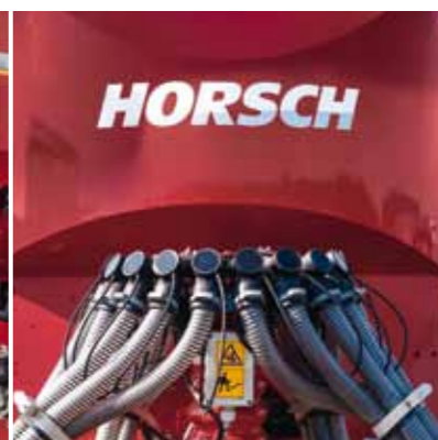
Датчики SeedControl делают калибровку нормы высева излишней
