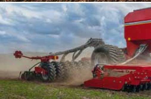
Шасси Pronto AS Большие колёса (800/40-26,5), с низким сопротивлением, не повреждающие почву при работе в поле
