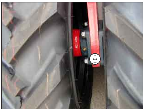
Опора вала почвоуплотнителя
