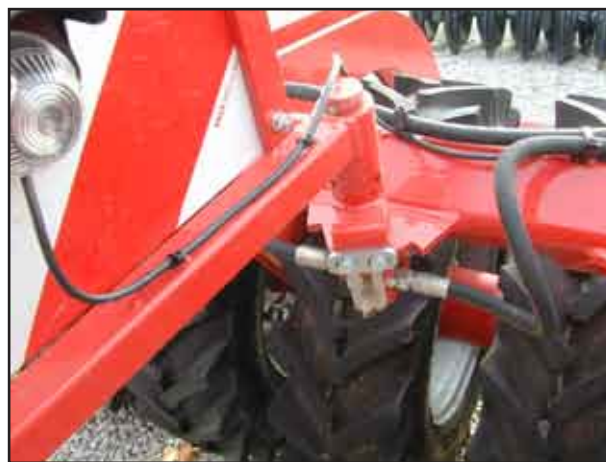
Кронштейн освещения с запорным краном
