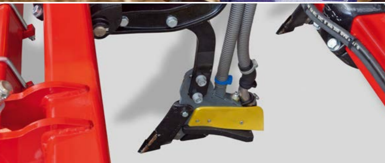
Сошник Дуэт с внесением гранулированных удобрений с блоком MultiGrip – комбинированный рабочий орган для одновременного посева и внесения удобрений
