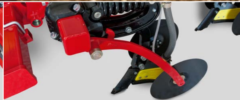
Сошник Duett для посева с одновременным внесением жидкого удобрения для Sprinter ST
