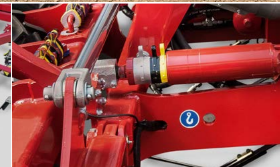
Индивидуальная настройка глубины работы дистанционными клипсами
