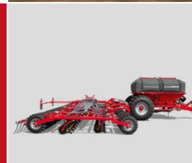
Sprinter 12 SW: Боковые опорные колеса в комбинации с межрядным почвоуплотнителем
