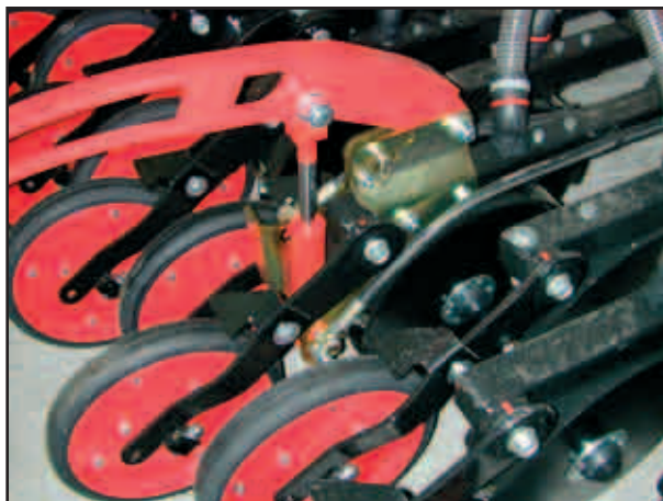
Регулировка высоты на предвсходовом маркере
