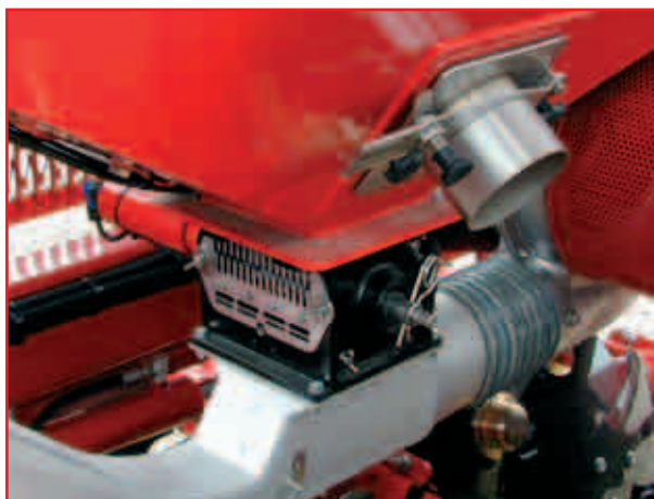
Дозатор с загрузочным шлюзом
