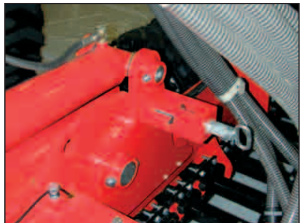
Фиксатор складывания сеялки
