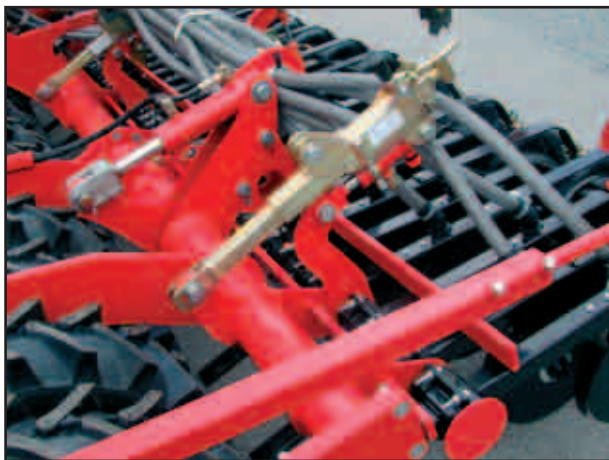
Гидравлическая система регулировки давления сошников
