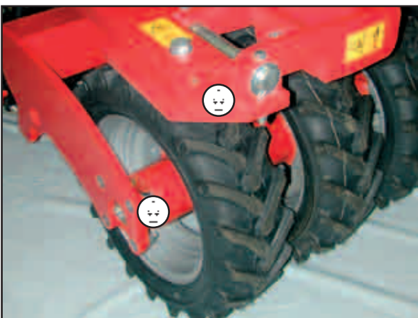
Поворотная точка маркера колеи и подшипник почвоуплотнителя
