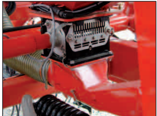
Дозатор с крышкой для загрузочного шлюза
