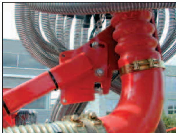
Регулировка башни распределителя
