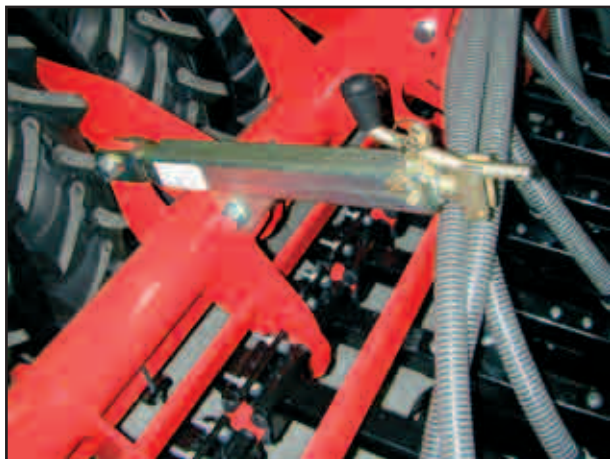
Регулирующий рычаг системы регулировки давления сошников
