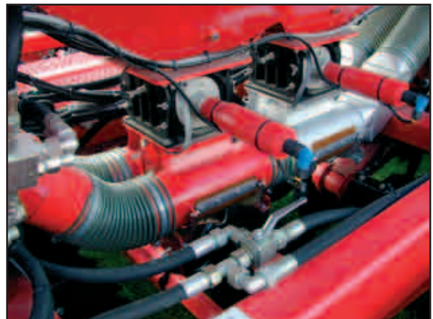
Дозаторы с приводом, спускным шлюзом и пневматической системой
