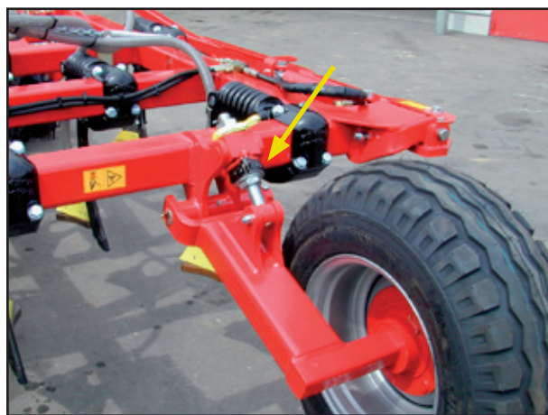
Регулировка глубины опорного колеса спереди
