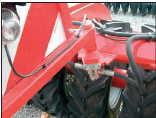
Кронштейн освещения с запорным краном
